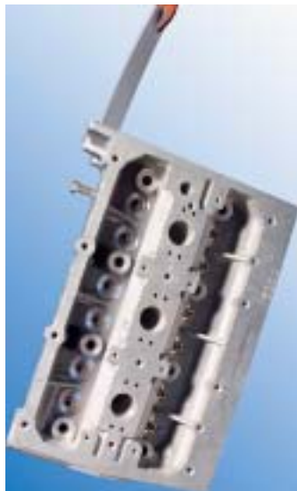
Die Probe aufs Exempel: Der 19,2 kg schwere Motorblock hängt an dem Alu-Blech, an das er mit AL85PLUS gelötet wurde Bild: RSI-Hinderer
