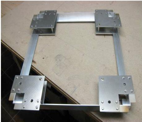
So werden alle vier Ecken gelötet und dann sollte man erst mal etwas warten bis alle Teile etwas abgekühlt sind.
