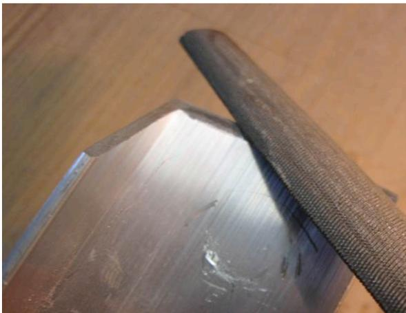
Anschließend wird eine Fase eingefeilt, in welche dann das Lot fließen kann.
