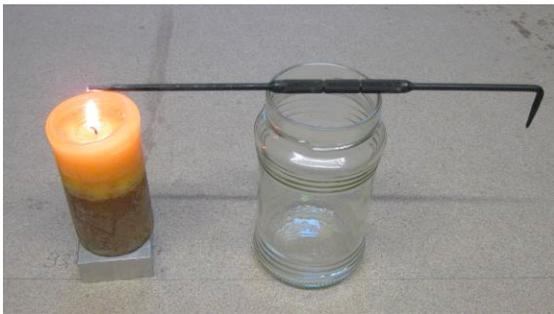
Die Nadel zum durchdringen der Oxidschicht wird schon mal vorgewärmt. Das erleichtert etwas die Lötung.
