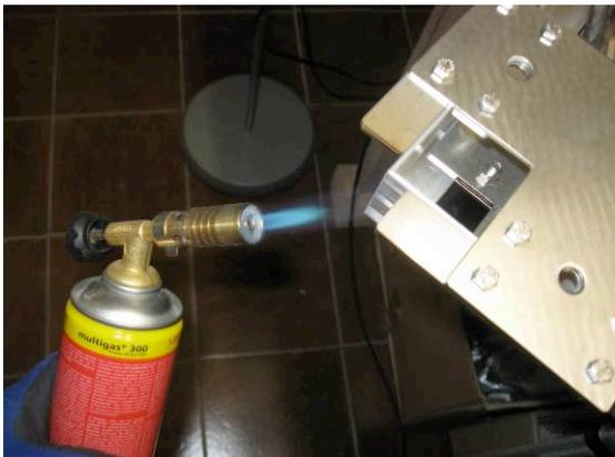
Der Lötvorgang startet. Die Ecke wird auf Temperatur gebracht.
